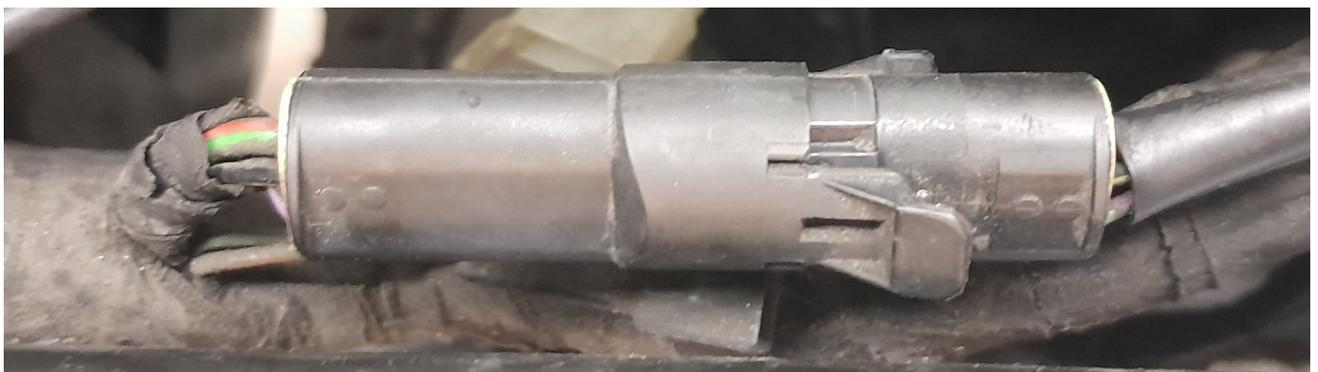
La prise servant de liaison entre le faisceau principal et le faisceau d'injection est prévue pour 5 broches , seules 4 sont montées
